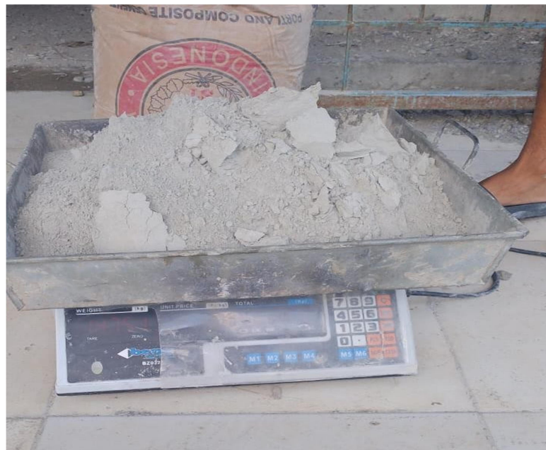
Proses penimbangan semen untuk pembuatan benda uji
