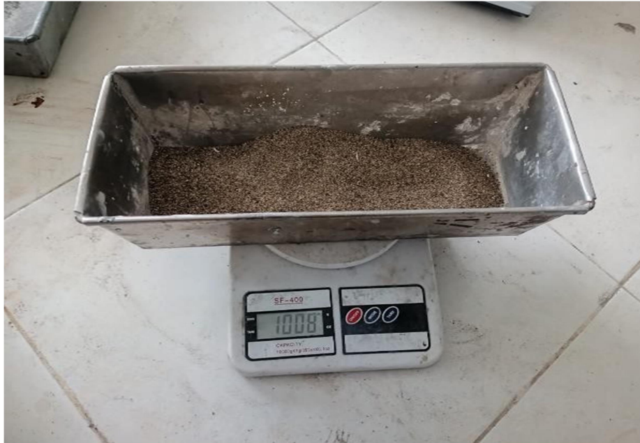
Proses penimbangan Agregat halus
