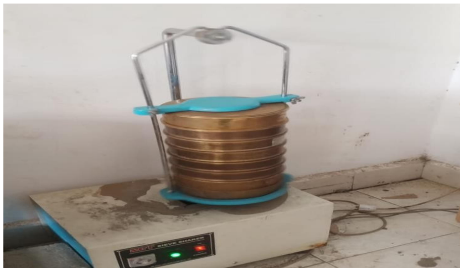
Proses Penyaringan Agregat Kasar
