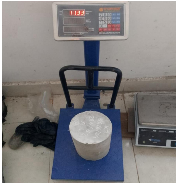
Proses penimbangan benda uji
