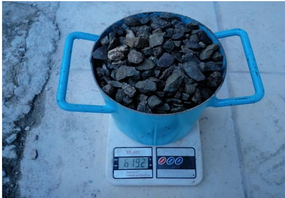
Pengujian berat isi agregat kasar
