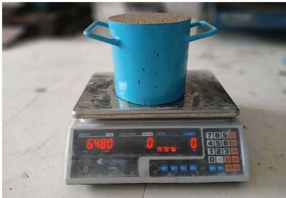
Pengujian berat isi agregat halus
