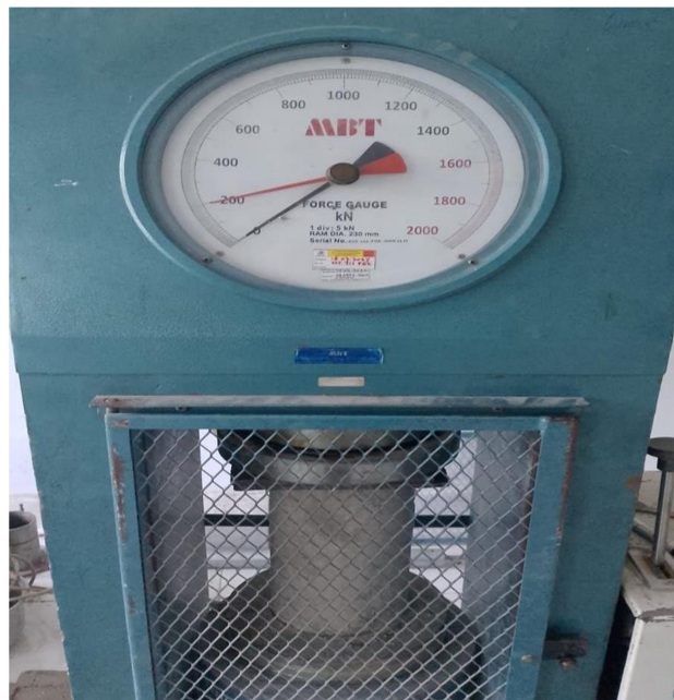
Pengujian kuat tekan beton
