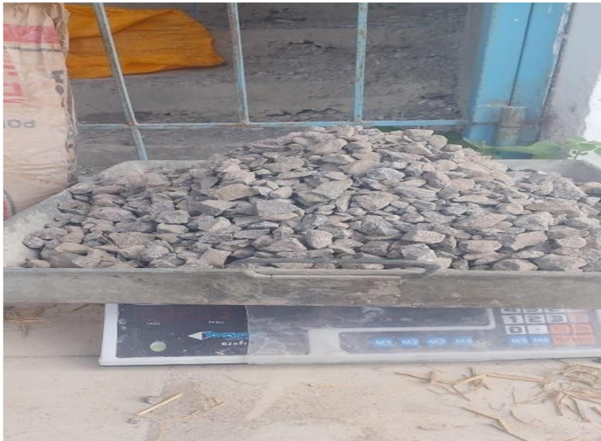
Proses penimbangan agregat kasar untuk pembuatan benda uji
