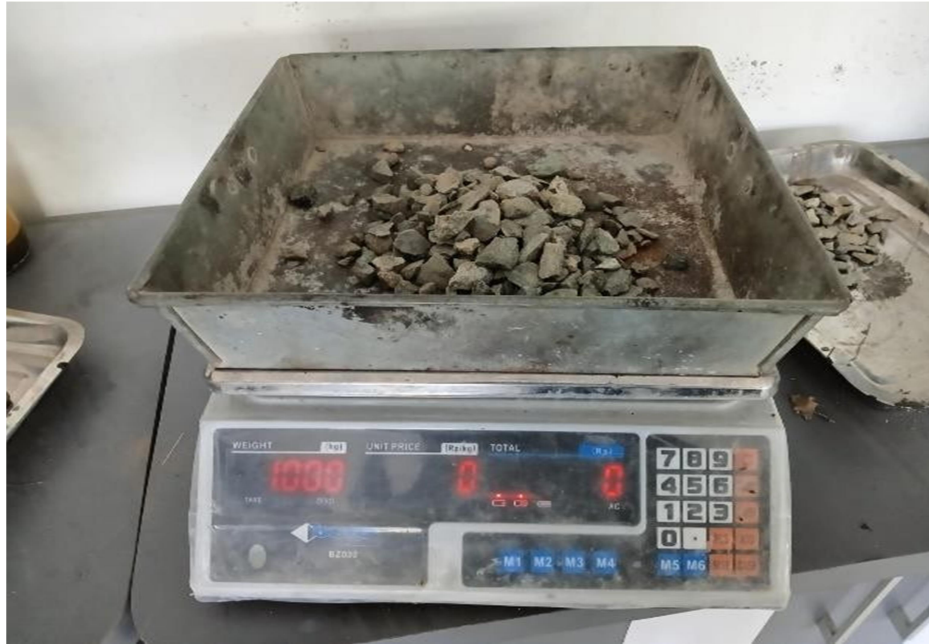
Proses Penimbangan Agregat Kasar Sebelum di Oven
