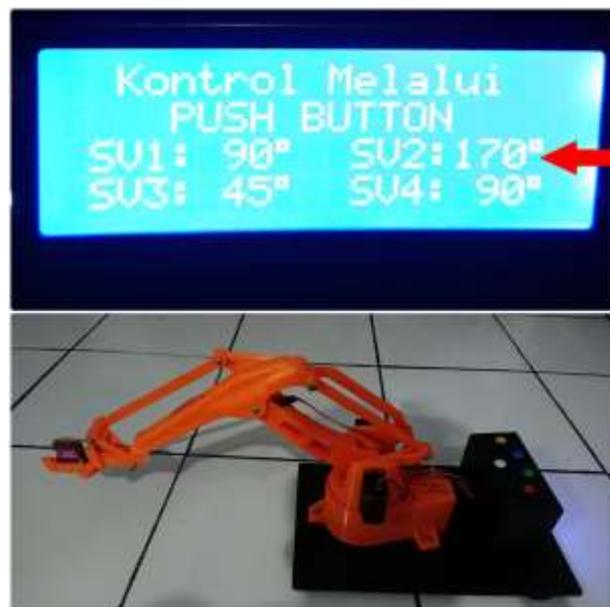
**Gambar 4. 6** pengukuran pergerakan lengan ke atas
