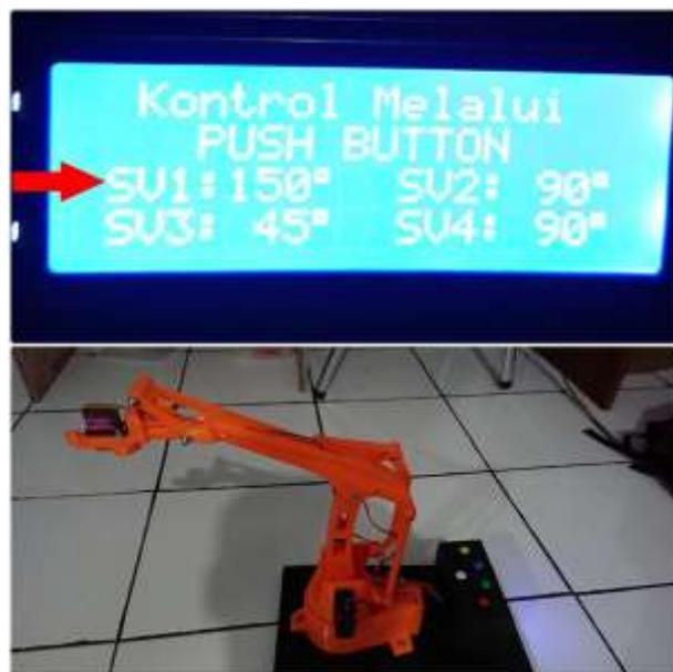
**Gambar 4. 8** pengukuran pergerakan lengan ke atas
