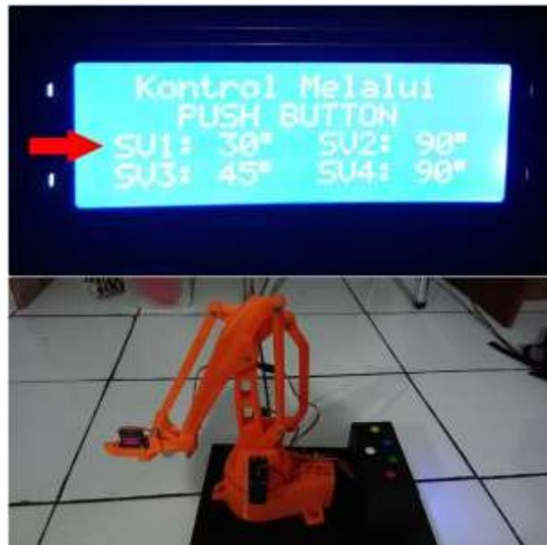
**Gambar 4. 7** pengukuran pergerakan lengan ke bawah
