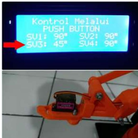
**Gambar 4. 9** Pengukuran pergerakan lengan membuka
