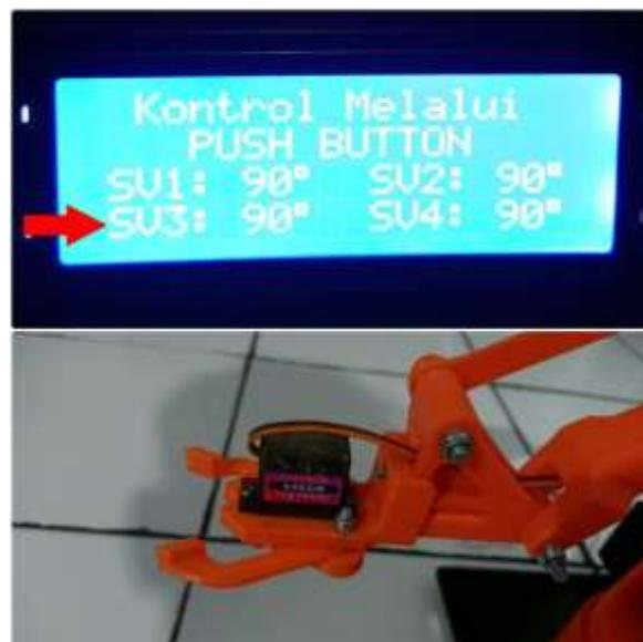
**Gambar 4. 10** Pengukuran pergerakan lengan menutup
