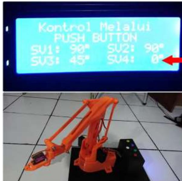
**Gambar 4. 11** Pengukuran pergerakan lengan ke kiri
