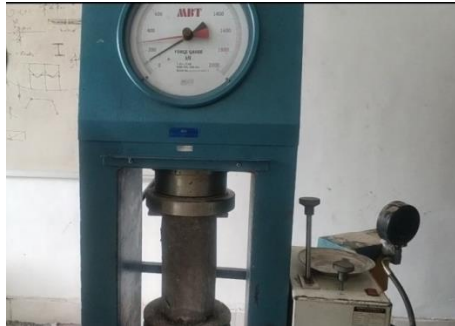
Gambar 2.4. Pengujian Kuat Tekan Pada Beton Sumber : Dokumntasi contoh pengujian kuat tekan beton
