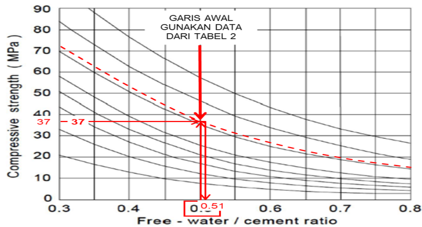
Gambar 4. 2 Grafik perkiraan faktor air semen (Sumber: SNI 03-2834:2000).
