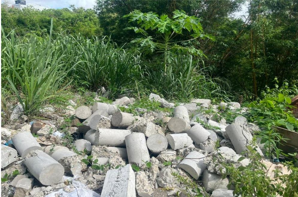
**Gambar 2. 1** Limbah beton di Laboratorium Struktur dan Bahan Univeristas Muhammadiyah Parepare
