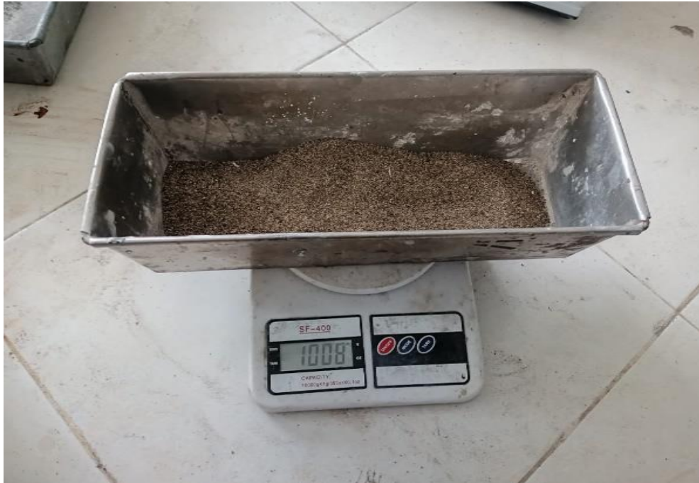
Proses penimbangan Agregat halus
