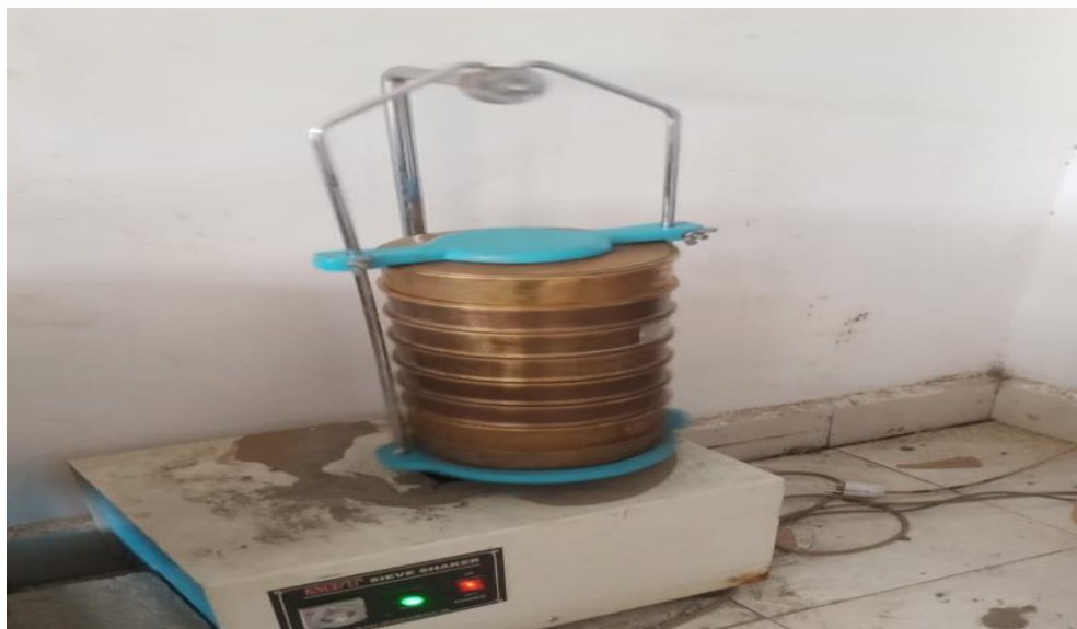
Proses Penyaringan Agregat Kasar
