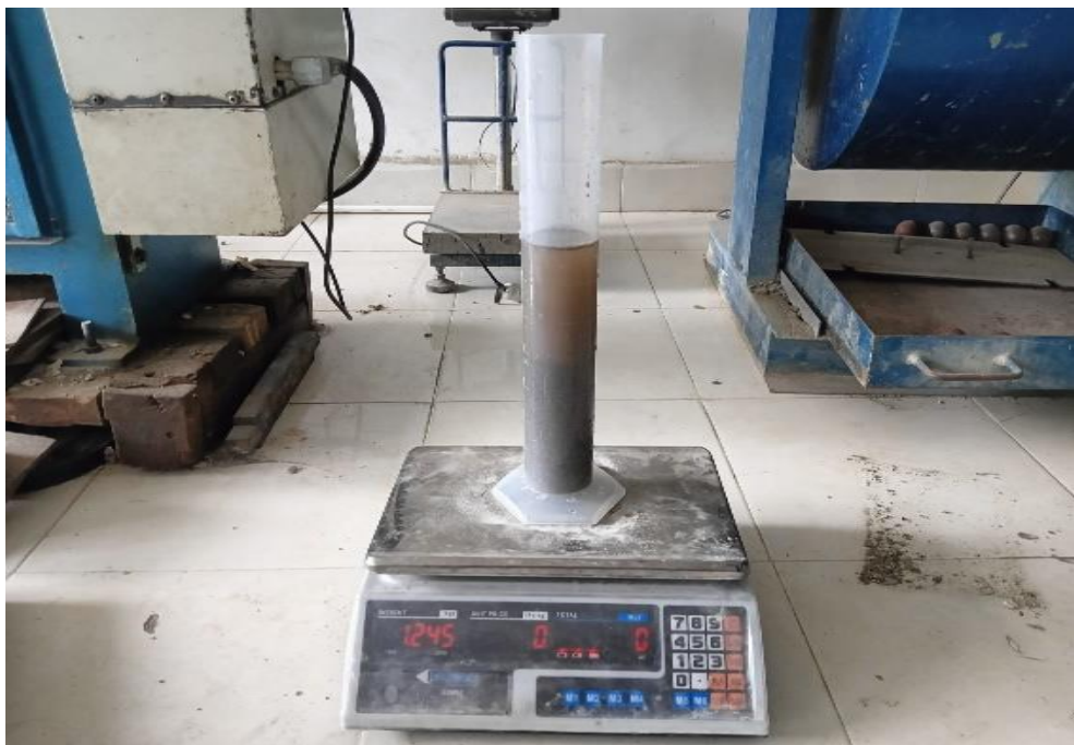
Penimbangan Pycnometer, air dan agregat halus
