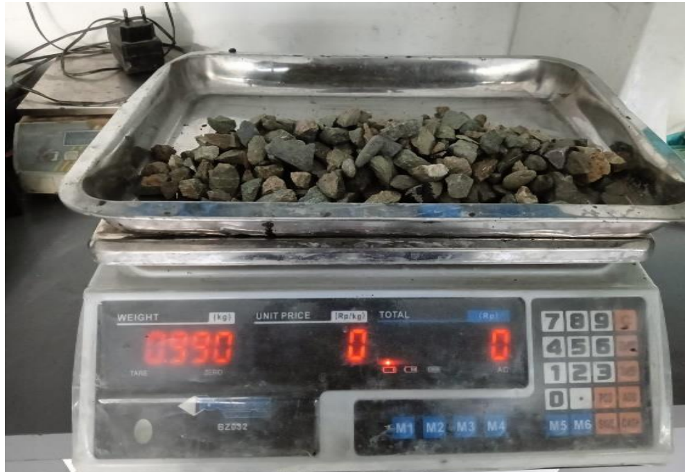
Proses Penimbangan Agregat sesudah di Oven
