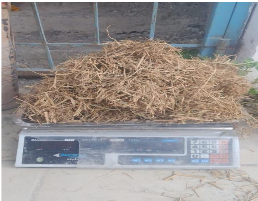
Proses penimbangan jerami untuk pembuatan benda uji
