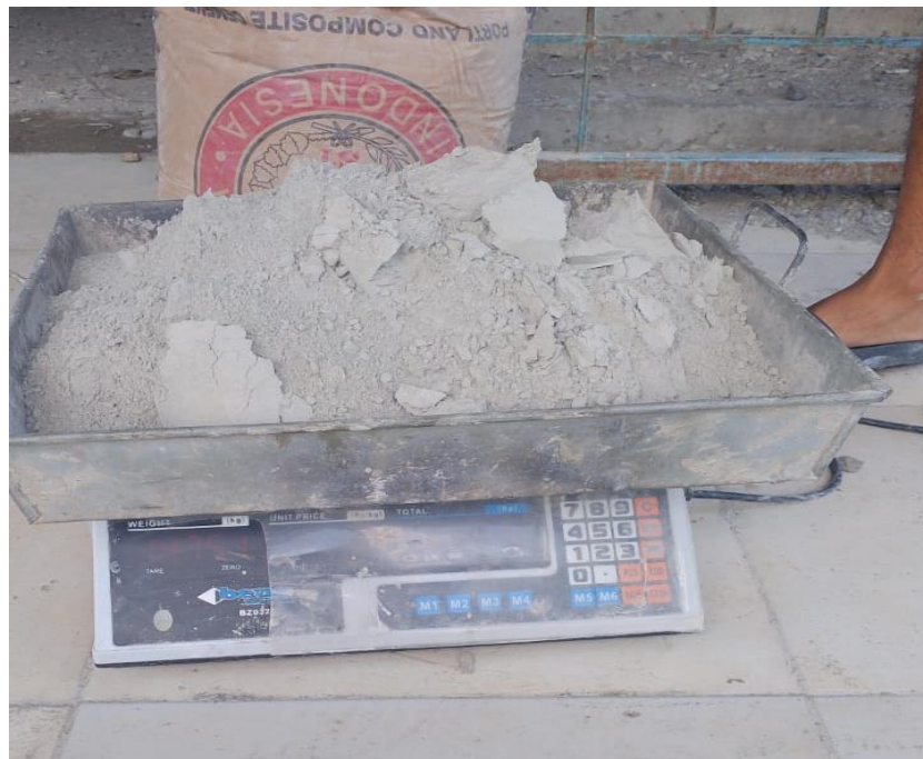
Proses penimbangan semen untuk pembuatan benda uji
