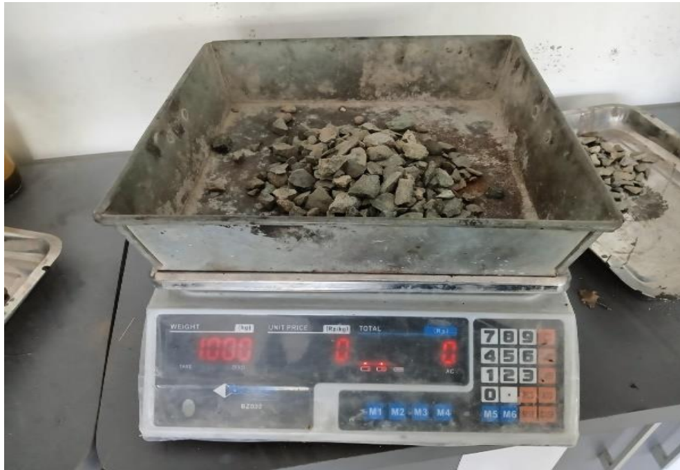
Proses Penimbangan Agregat Kasar Sebelum di Oven
