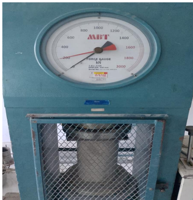
Pengujian kuat tekan beton
