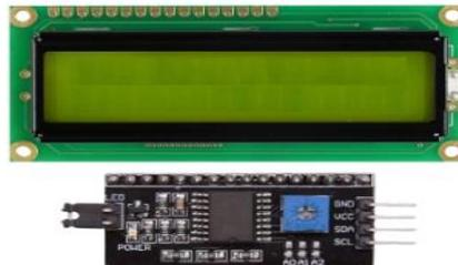
**Gambar 2.10** Modul LCD dan IIC/I2C
