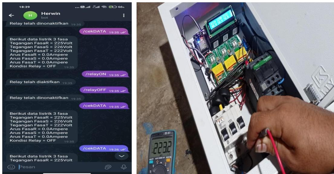
**Gambar 4.8** pengujian Tegangan 3 Phese
