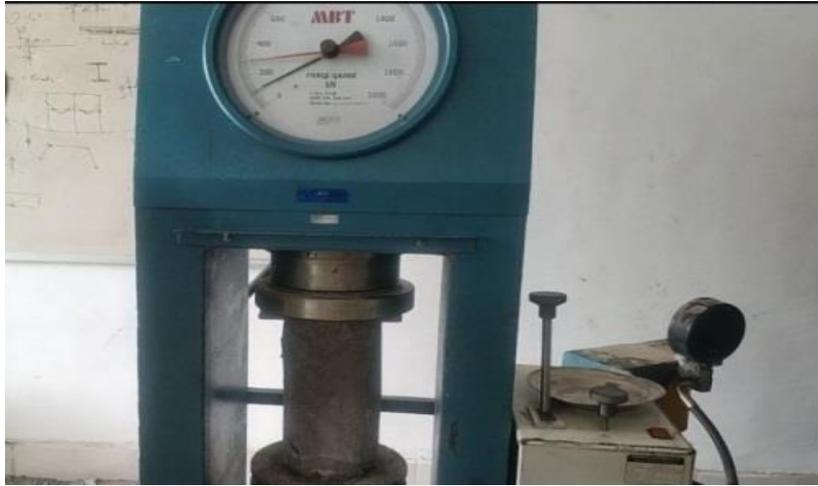
**Gambar 2. 2** Pengujian Kuat Tekan Pada Beton (*Sumber : Dokumentasi contoh pengujian kuat tekan beton*)
