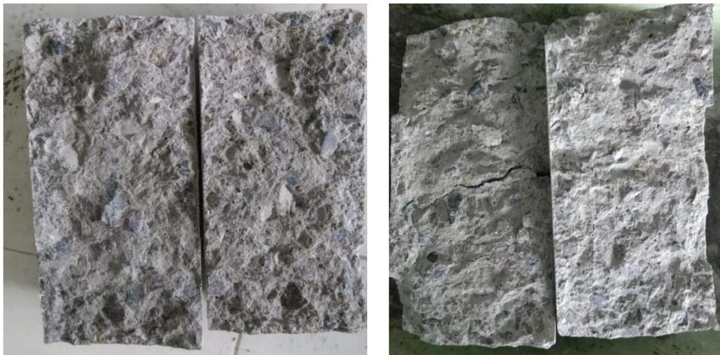
Gambar 4. Dokumentasi Pengujian Tarik Belah Pada Benda Uji
