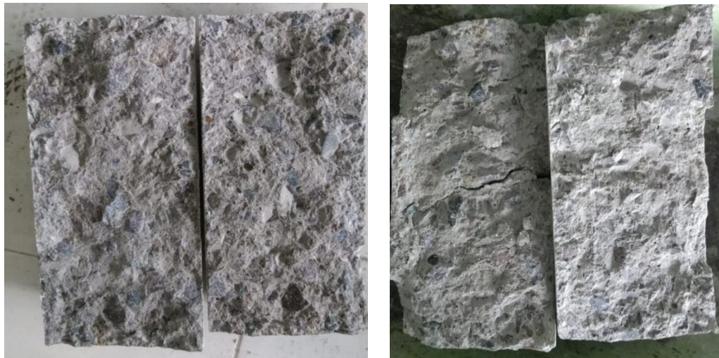
Gambar 4.2 Dokumentasi pengujian tarik belah pada benda uji
