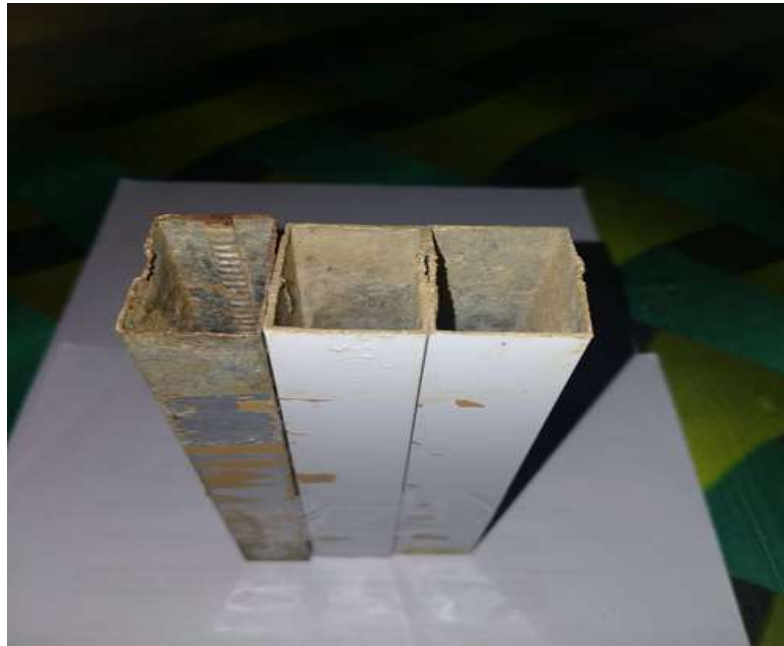
Gambar 7: Baja yang Digunakan Sebagai Drainase Buntu
