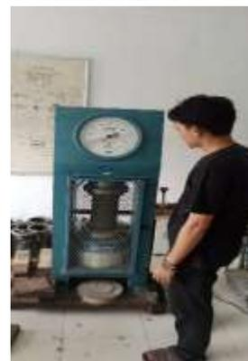
**Gambar 4.** Pengujian Kuat tekan beton
