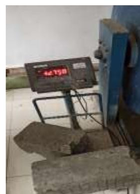
**Gambar 5.** Pengujian Kuat lentur beton
