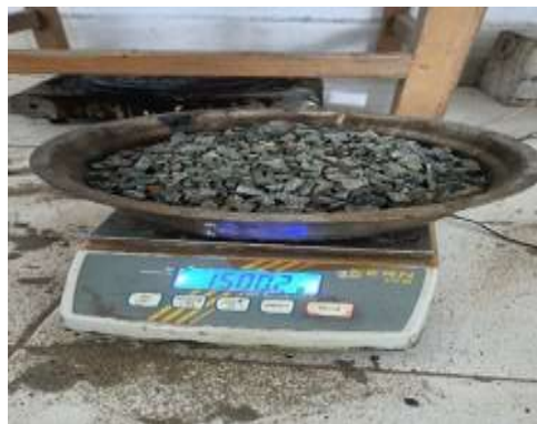
Penimbangan berat agregat
