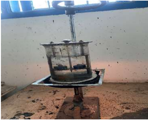
Pengujian titik lembek
