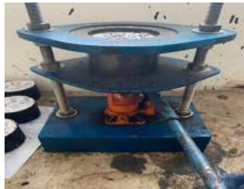
Mengeluarkan sampel dari cetakan
