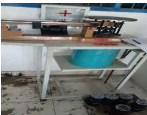
Proses penimbangan dalam air
