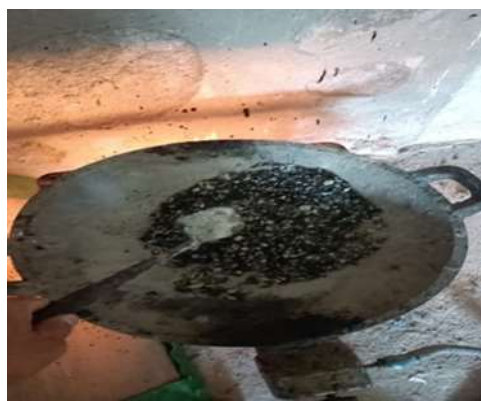
Pemanasan campuran agregat
