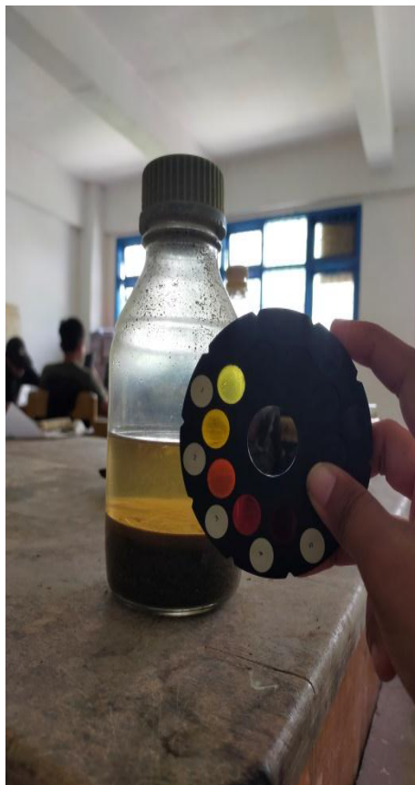
Pemeriksaan kadar organik agregat halus (pasir sungai)
