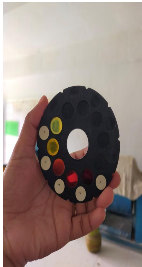
Pemeriksaan kadar organik agregat halus (pasir sungai)
