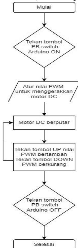
**Gambar 4.** *Flowchart* Prinsip Kerja Sistem Kendali pada Mesin Pemipil Jagung
