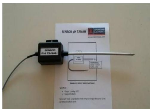
Gambar 4.8 Sensor pH Tanah
