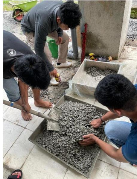
Pemadatan plat untuk pengujian permeabilitas
