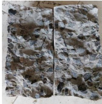
Gambar 9. Gambar Tarik Belah Beton Variasi 0,5%
