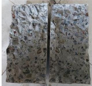
Gambar 8. Gambar Tarik Belah Beton Normal
