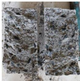
Gambar 12. Gambar Tarik Belah Beton Variasi 2,0%
