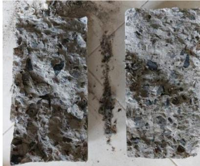
Gambar 10. Gambar Tarik Belah Beton Variasi Serat 1,0%
