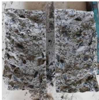
Gambar 11. Gambar Tarik Belah Beton Variasi 1,5%
