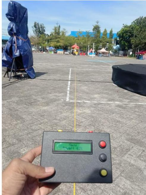
**Gambar 4.6** Gambar pengujian jarak antara remot kontrol dengan perahu
