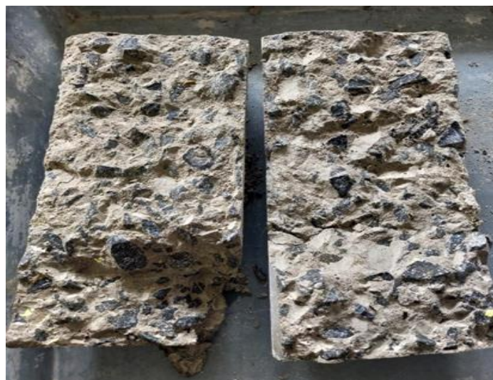
Gambar 7. Tarik Belah Beton Normal
