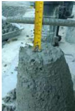
Gambar 2. Pengujian Slump
