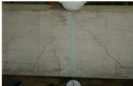
Gambar. 27 Pola retak beton normal
