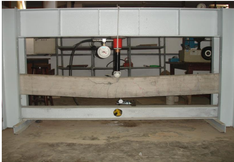
Gambar. 30 Pola runtuh balok beton bertulang
