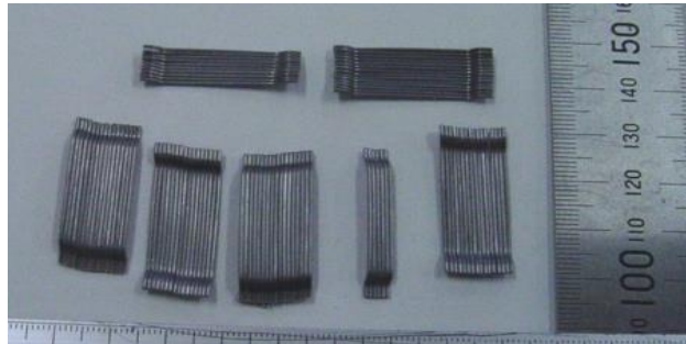
Gambar 4. The bundling of the fibers (dimension = mm) Kondisi fiber-fiber yang dicampur dengan lem sebelum dicor
