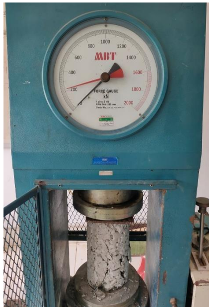
PENGUJIAN KUAT TEKAN
