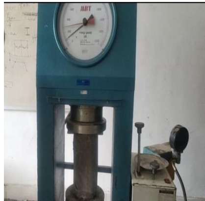
Gambar 5. Pengujian Kuat Tekan Pada Beton Sumber: Dokumentasi contoh pengujian kuat tekan beton
