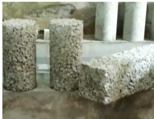
Gambar 1. Beton Porous (Berongga) ( Sumber: Dokumentasi Pribadi )
