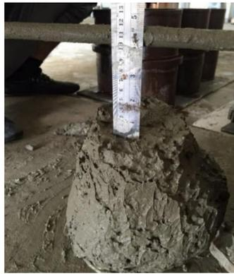
**Gambar 5.** Pengujian *slump test*.
