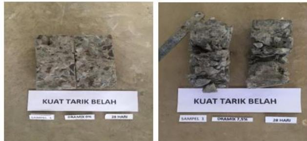
**Gambar 20.** Kondisi benda uji silinder setelah dibelah.
