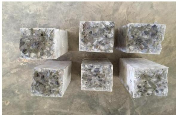
**Gambar 21.** Kondisi benda uji balok setelah dibelah.
