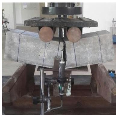
**Gambar 19.** Pola keruntuhan pada pengujian lentur.
