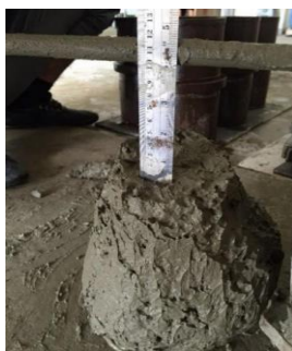
Gambar 3. Pengujian slump test .
