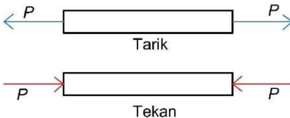
Gambar 8.12. Gaya aksial yang terjadi pada penampang balok
