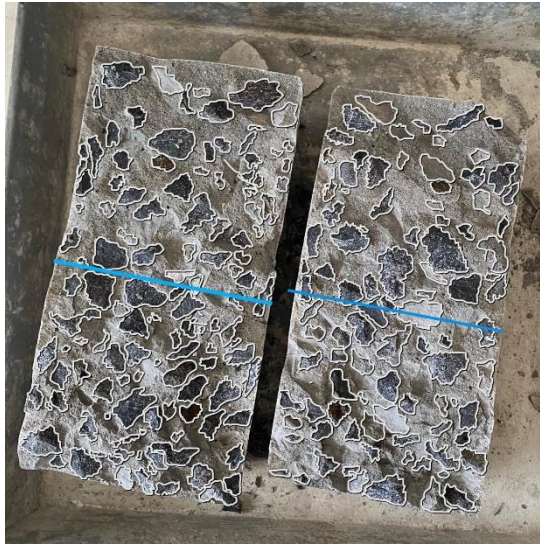
Gambar 4.11 Hasil Tarik belah beton SF 4% (Sumber: Dokumentasi pribadi)
