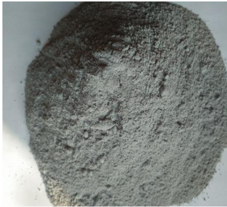
Gambar 2.1 Zat adiktif Silika fume (Sumber: Dokumentasi Pribadi)
