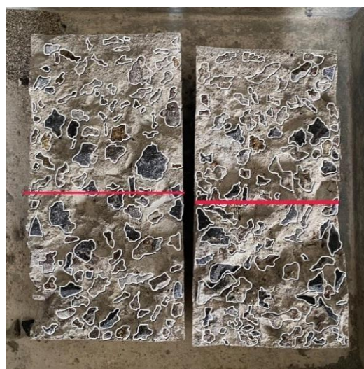
Gambar 4.12 Hasil Tarik belah beton SF 8% (Sumber: Dokumentasi pribadi)
