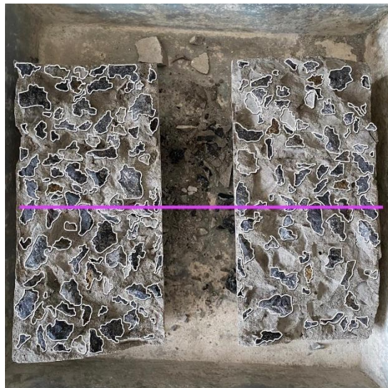
Gambar 4.10 Hasil Tarik belah beton normal (Sumber: Dokumentasi pribadi)
