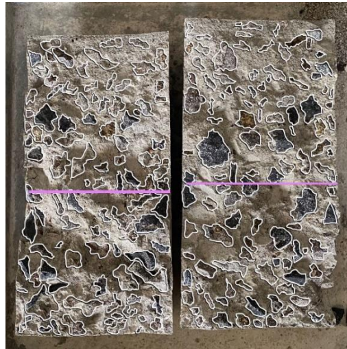
Gambar 4.13 Hasil Tarik belah beton 12% (Sumber: Dokumentasi pribadi)
