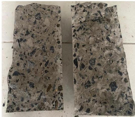
**Gambar 4. 6** Gambar tarik belah beton normal (Sumber : Dokumentasi pribadi)
