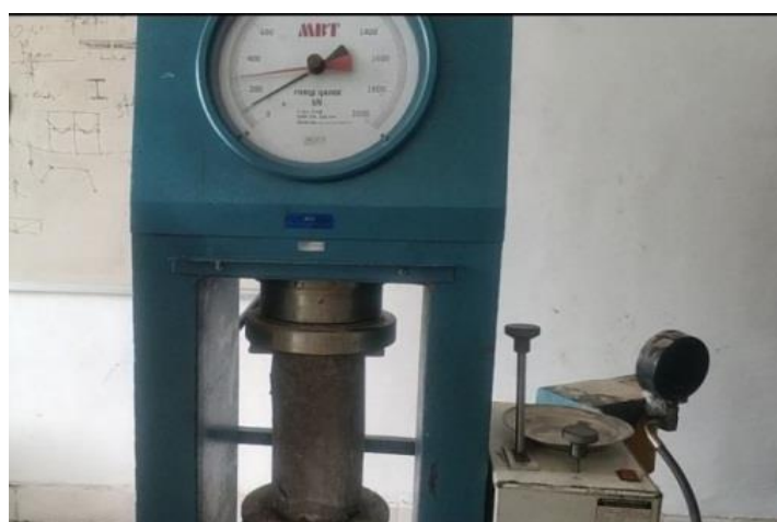
Gambar 2.6 Pengujian Kuat Tekan Pada Beton Sumber : Dokumentasi contoh pengujian kuat tekan beton
