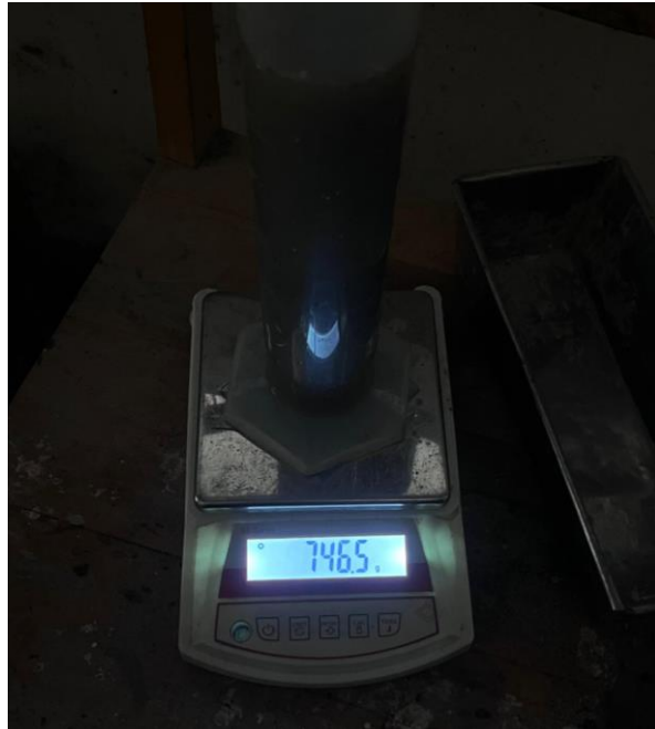
Pengujian berat jenis agregat halus pasir
