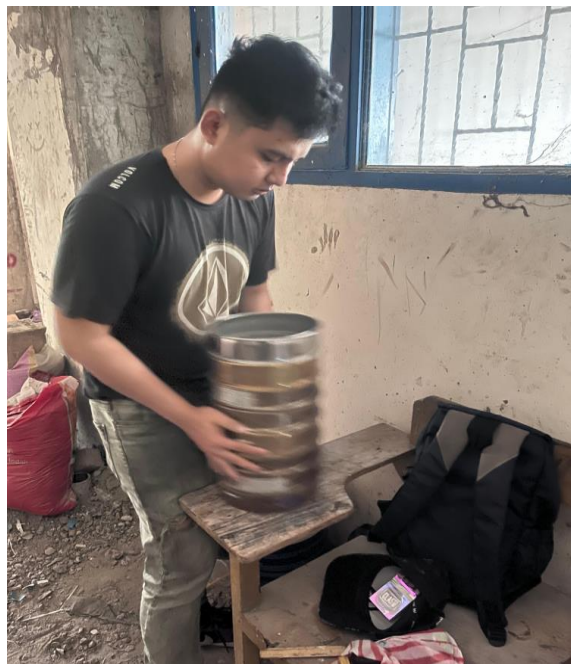
Pengujian analisa saringan agregat halus pasir
