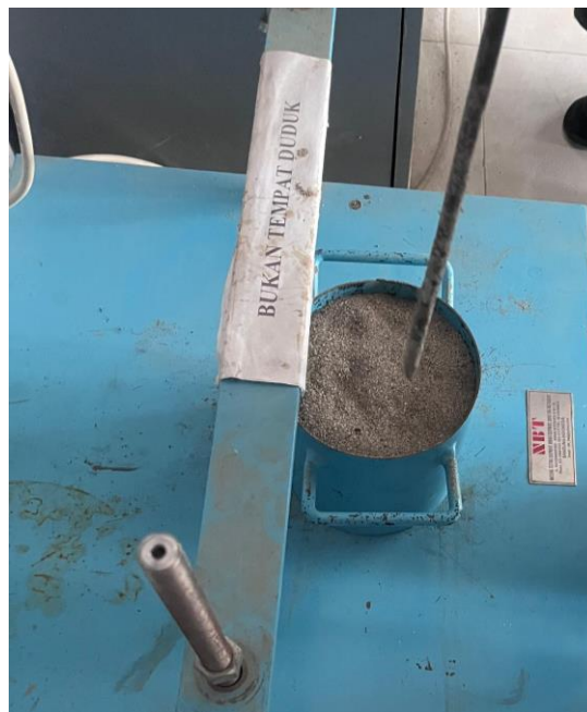
Pengujian berat volume agregat halus pasir
