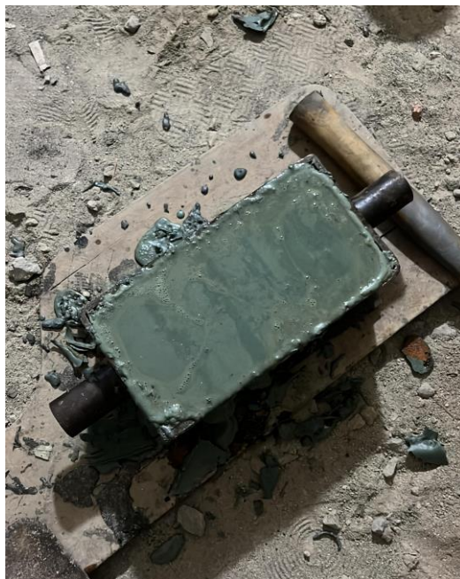
Tampak paving block keadaan masih cair
