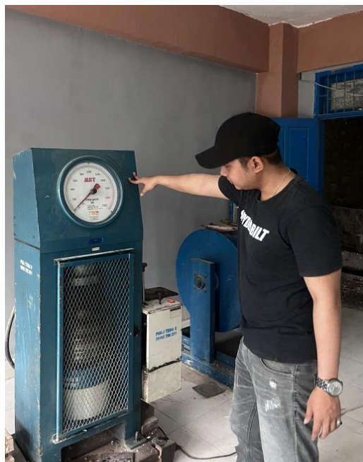
Pengujian kuat tekan paving block
