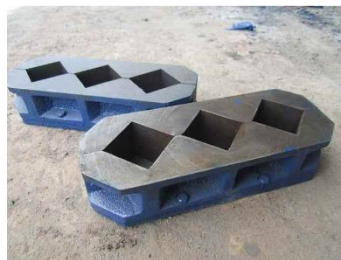
Gambar 3. 8 Cetakan Beton (Sumber: dokumentasi pribadi)
