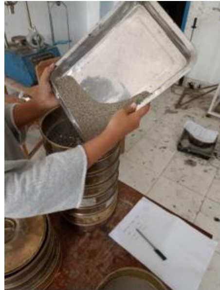
Pemeriksaan analisa saringan agregat
