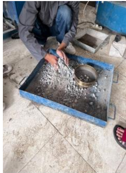
Pemeriksaan keausan agregat kasar (kerikil) dengan mesin Los Angeles
