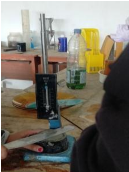
Pengujian waktu mengikat awal dan mengeras semen
