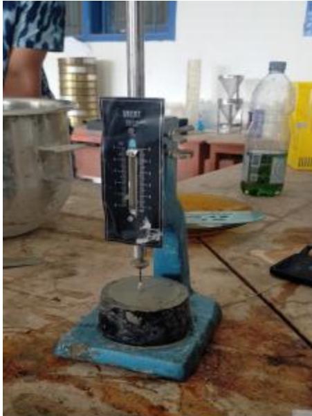
Pengujian konsistensi normal semen
