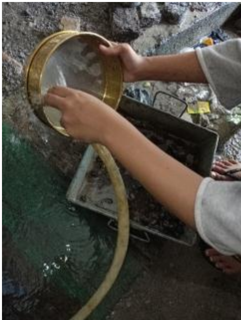
Pemeriksaan kadar lumpur agregat kasar
