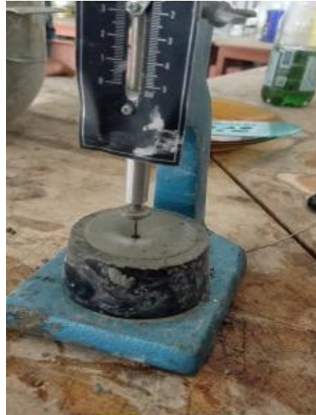
Pengujian konsistensi normal semen
