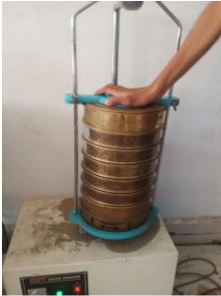
Pemeriksaan analisa saringan agregat
