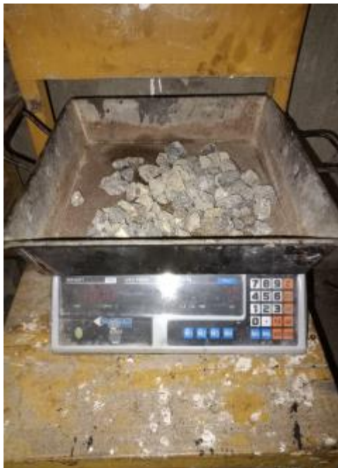
Pemeriksaan kadar air agregat kasar
