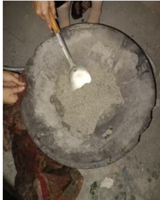
Pemeriksaan kadar air agregat halus
