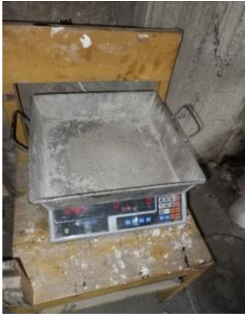
Pemeriksaan kadar air agregat halus
