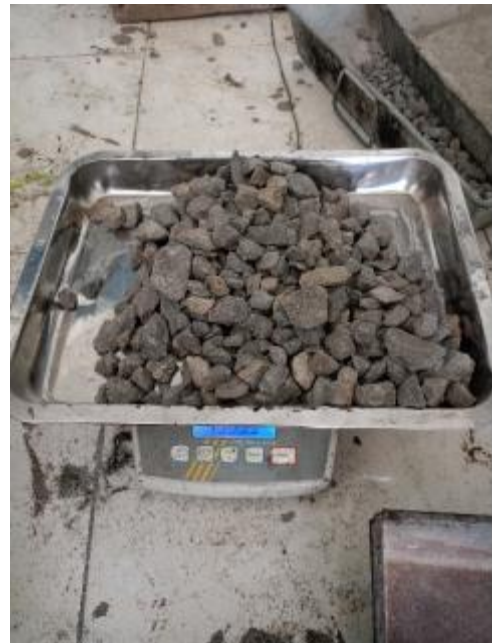
Pemeriksaan kadar lumpur agregat kasar
