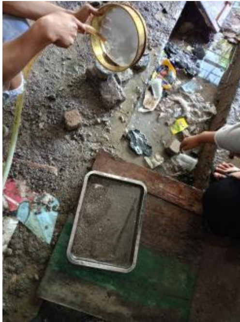
Pemeriksaan kadar lumpur agregat halus
