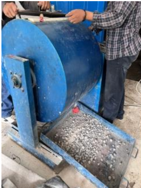
Pemeriksaan keausan agregat kasar (kerikil) dengan mesin Los Angeles
