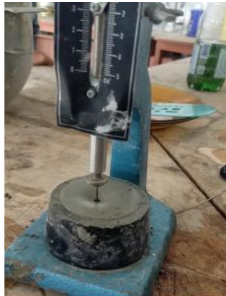
Pengujian waktu mengikat awal dan mengeras semen
