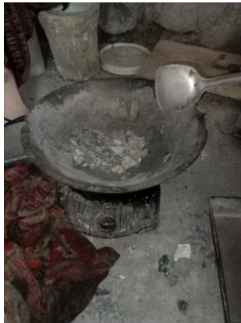
Pemeriksaan kadar air agregat kasar
