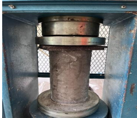
Gambar 2. 2 Pengujian Kuat Tekan Pada Beton (Sumber : Dokumentasi pribadi)
