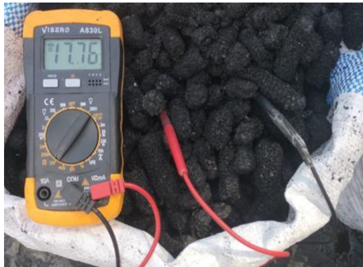
Gambar 5. Pengukuran EC meter pada biochar dengan menggunakan alat Digital Multimeter ( data hold)
