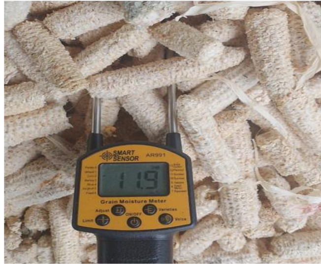
Gambar 1. Pengukuran Kelembapan dengan menggunakan alat Grain Moisture Meter
