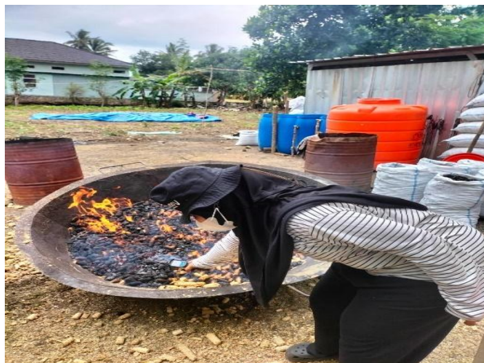
Gambar 2. Pengukuran suhu dengan alat Industrial Infrared Thermometer pada proses pembuatan biochar
