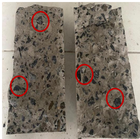
Gambar 4. 7 Sebaran agregat halus beton normal (Sumber : Dokumentasi pribadi)
