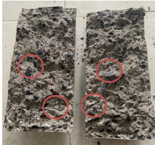
Gambar 4. 6 Sebaran Agregat halus beton Additive (Sumber : Dokumentasi pribadi)
