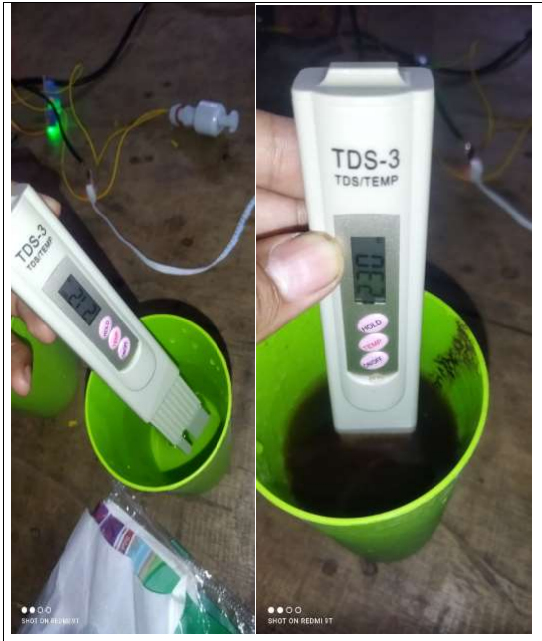
LAMPIRAN-4 Gambar Pegujian Sensor kekeruhan air dengan TDS Meter
