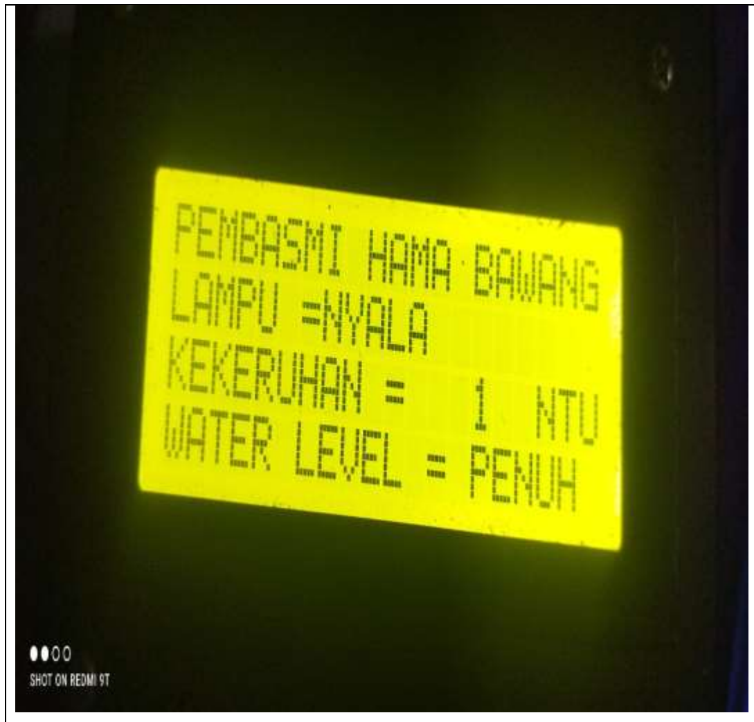
LAMPIRAN-5 Gambar Display LCD dengan ket nilai sensor TDS (kekeruhan), dan ketinggian air (water level)
