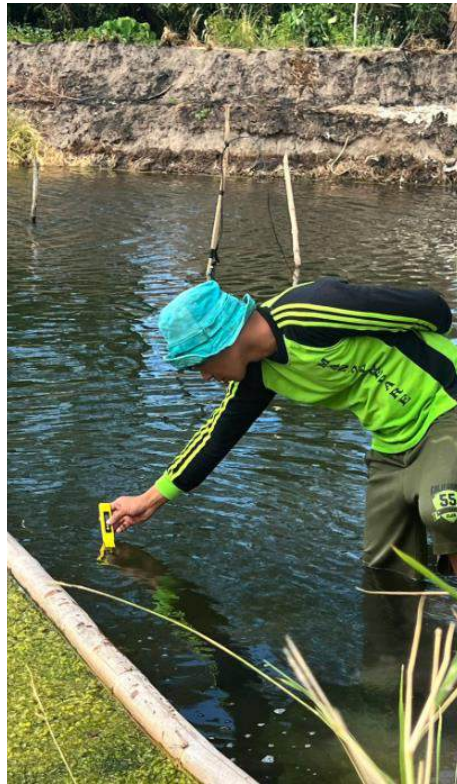
Gambar 4.32 Pengambilan Sampel pH Air menggunakan Pengukur pH
