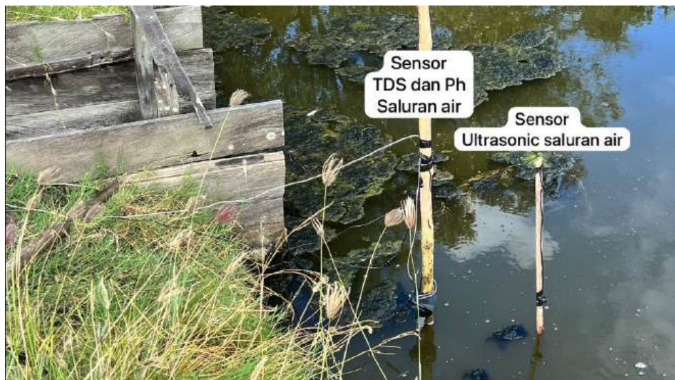
Gambar 4.31 Penempatan Sensor Pada Saluran Air
