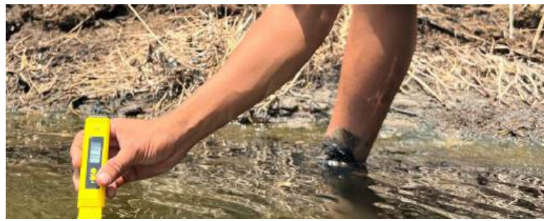
Gambar 4.24 Pengambilan data pH air tambak
