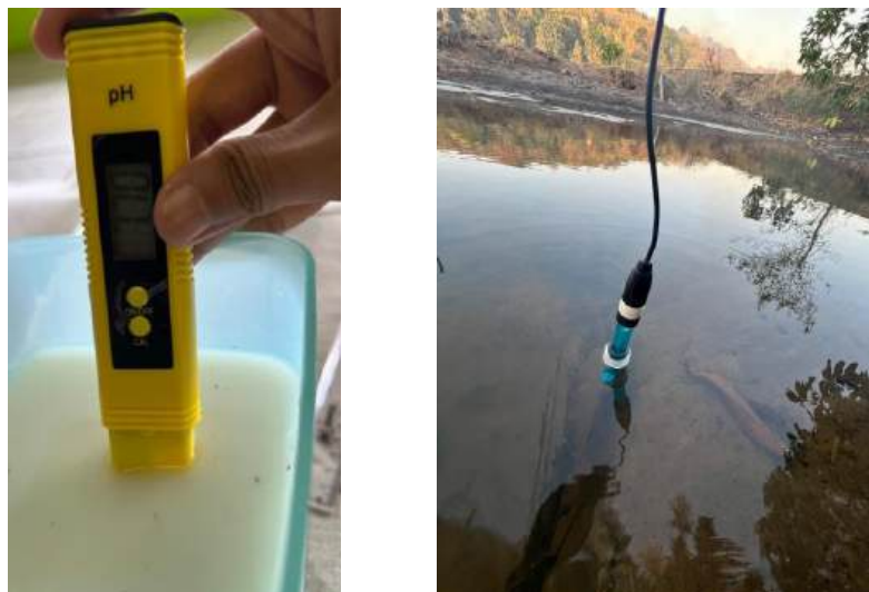
Gambar 4.26 Pengujian lapangan sensor pH down
