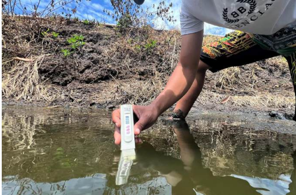
Gambar 4.27 Pengambilan nilai salinitas air tambak
