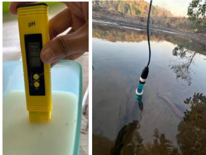
Gambar 4.25 Pengujian lapangan sensor pH UP
