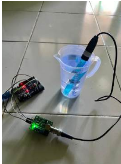
Gambar 4.13 Pengujian sensor pH UP
