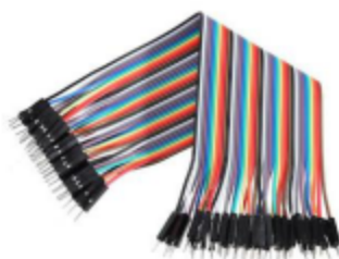
Gambar 2. 6 Kabel Jumper (Sumber: Prasetyo, E, A. 2023)
