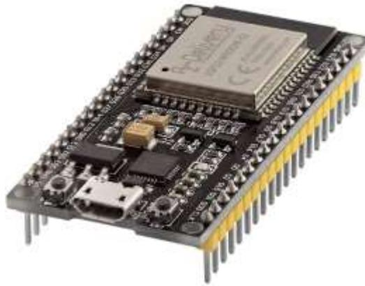
**Gambar 2. 4** *Nodemcu ESP32*
