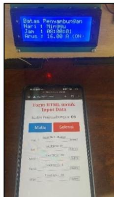
**Gambar 8.** Tampilan batas waktu penyambungan *Form HTML* dengan LCD
