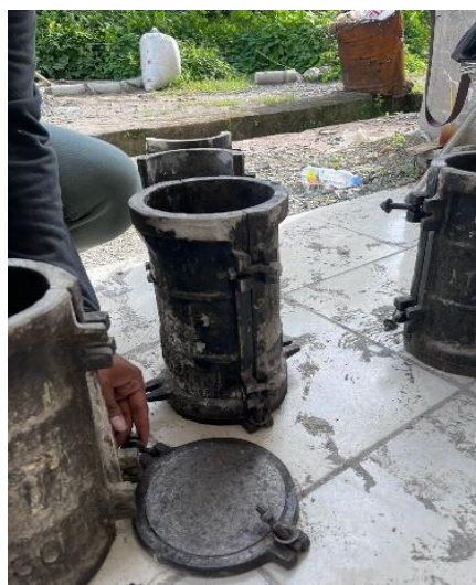
Gambar 3. 5 Cetakan beton (Sumber :Dokumentasi Pribadi)
