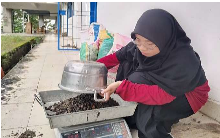
Penimbangan agregat kasar
