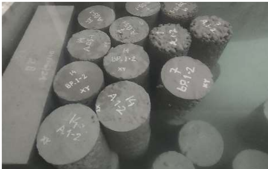
Curing/Perawatan benda uji pada bak air
