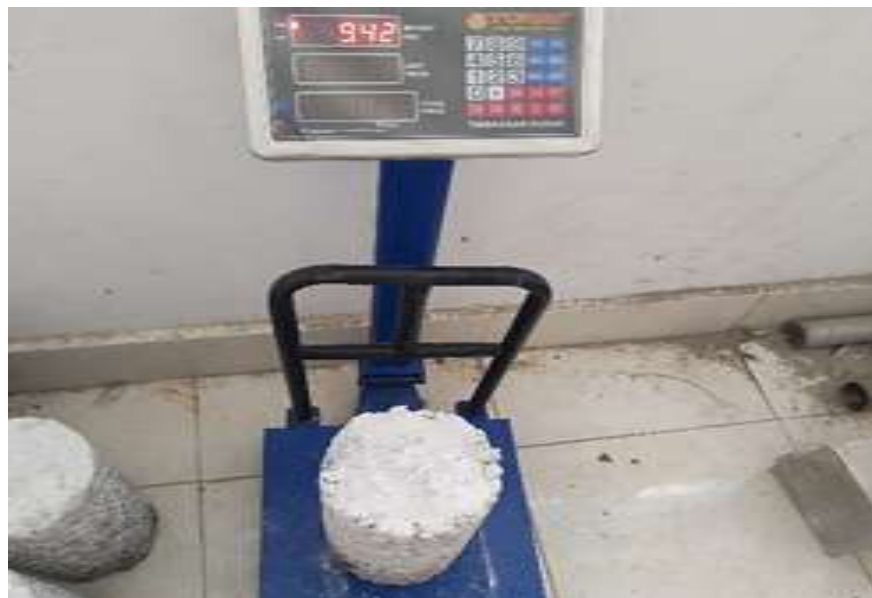
Penimbangan benda uji sebelum pengujian
