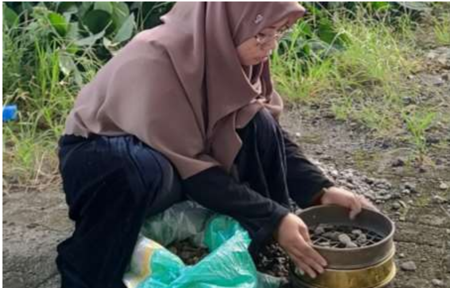
Penyaringan butir agregat kasar
