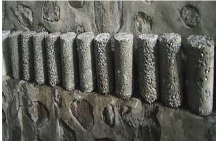
Pengangkatan benda uji setelah perendaman
