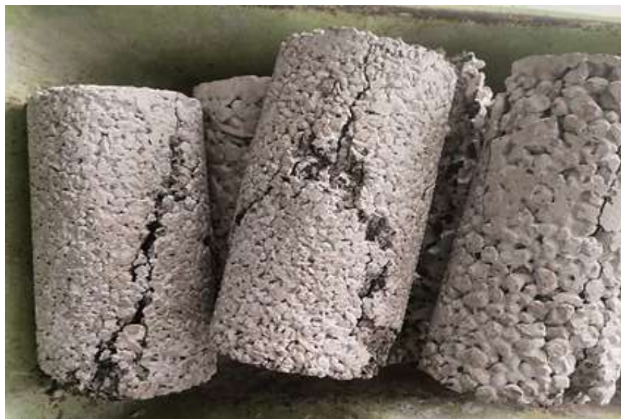
Kondisi benda uji setelah pengujian kuat tekan
