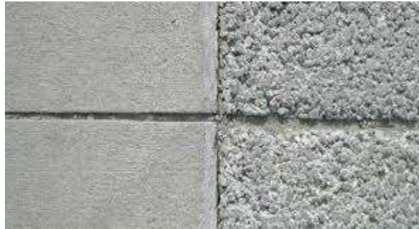
Gambar 2. 1 Perbedaan Tekstur Permukaan Beton Berpori dengan Beton Normal (Sumber: Florida Concrete & Product Assosiation )
